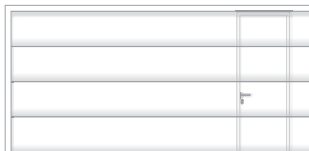
Asymmetrisk plassering ved portbredde for BRB 2000 - 3500 mm - fra midten mot venstre eller høyre
