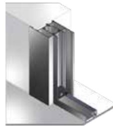
E: Montering i dagslysåpningen med en remse på innsiden
