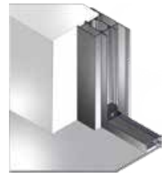
F: Montering i dagslysåpningen med en remse på utsiden
