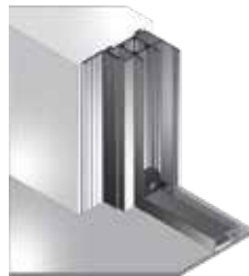
D: Montering i dagslysåpningen ved bruk av smal monteringsprofil
